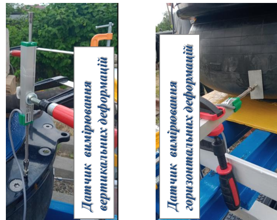
Рис. 4. Вигляд встановлених потенціометричних датчиків лінійних переміщень на пневматичній ресорі швидкісного рухомого складу
