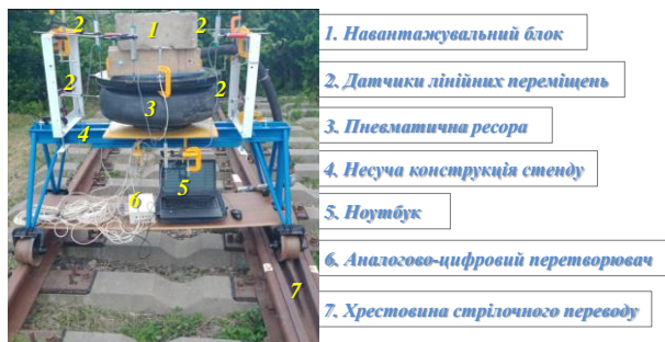
Рис. 3. Стенд для дослідження деформування пневматичної ресори
