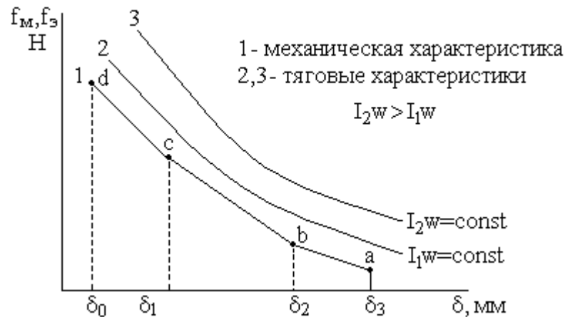
Рисунок. 2.10 – Механічна й тягова характеристики електромагнітного реле
