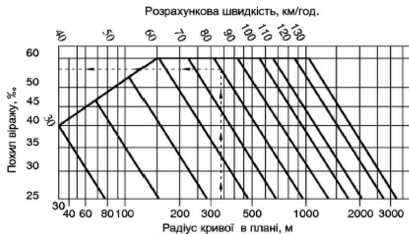
Рисунок 1.2 – Номограма для визначення похилу віражу [7,13-15]
