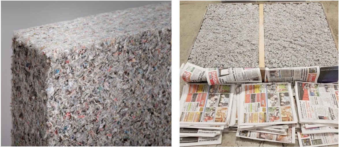
Рис. 3.13 - Теплоізоляція із целюлози
