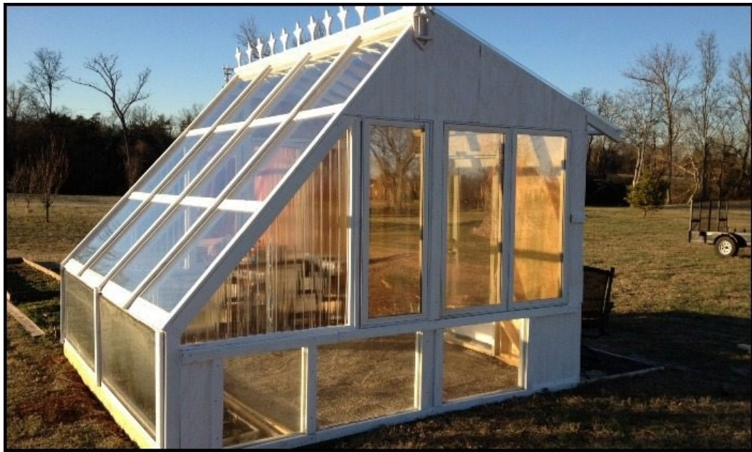
Рис. 3.22 - Апсайклінг скла (повторне використання у теплиці) [55]
