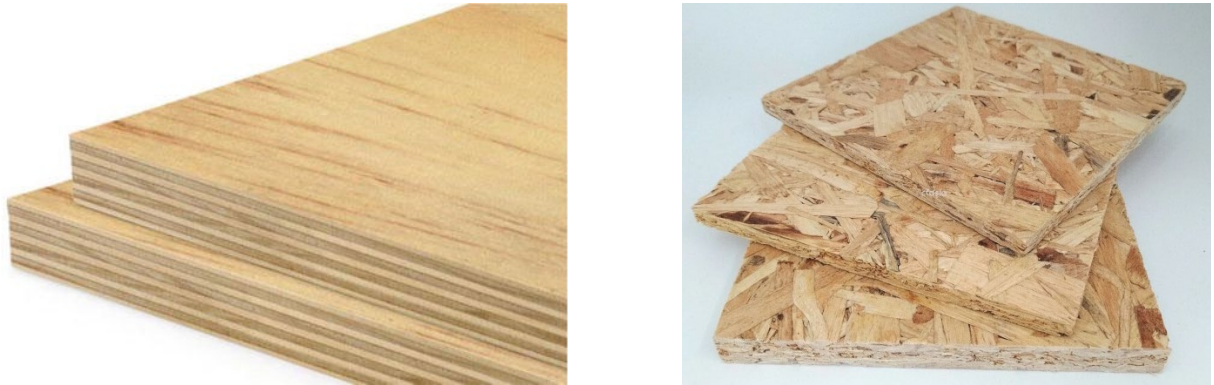
Рис. 3.9 - Фанера та OSB [47]
