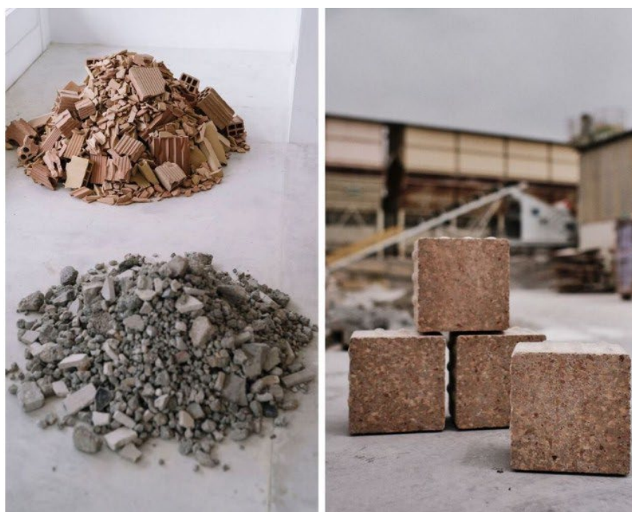
Рис. 3.20 - Рециклінг цегли шляхом подрібнення у вторинний заповнювач [53]
