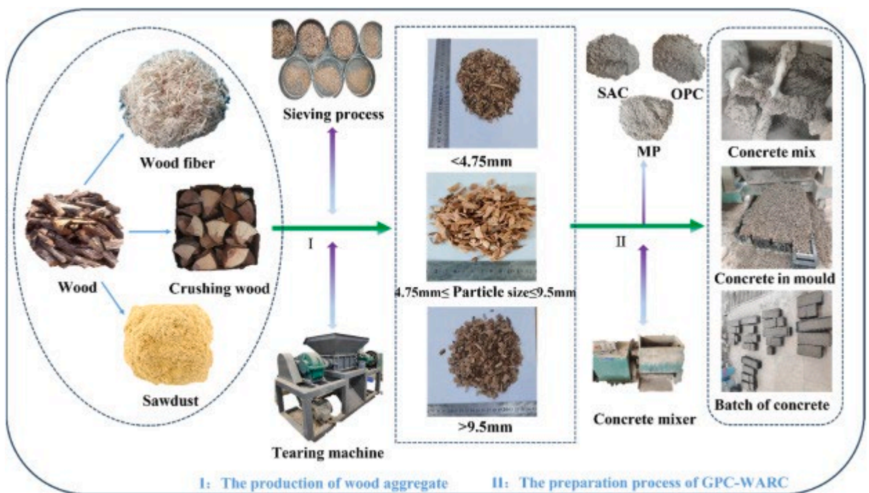
Рис. 3.1 - Виробництво бетону із заповнювачем з деревини [42]
