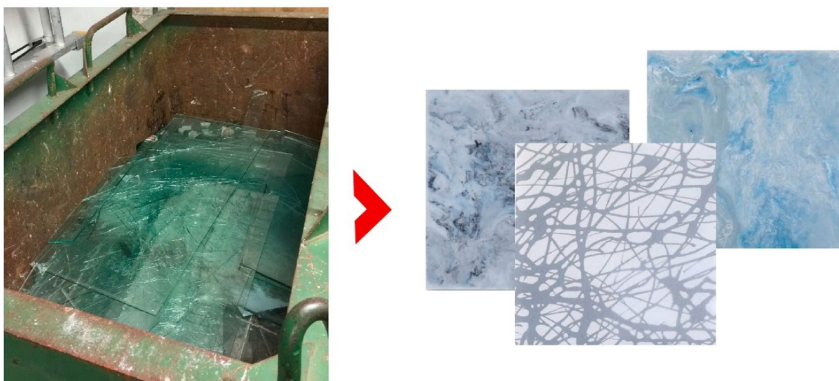
Рис. 3.21 - Рециклінг віконного скла для склополімерних виробів [54]
