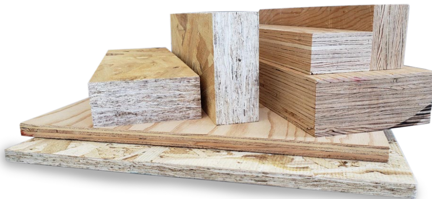
Рис. 3.7 - Клеєний дерев'яні елементи з орієнтованою стружкою (LSL) [47]
