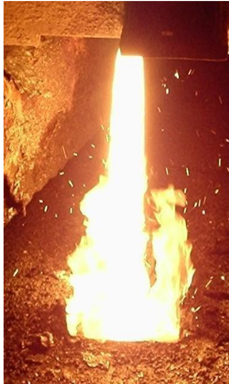
Рисунок 4.3 – Порушення компактності характеру витікання струменя металу («віяла»)
