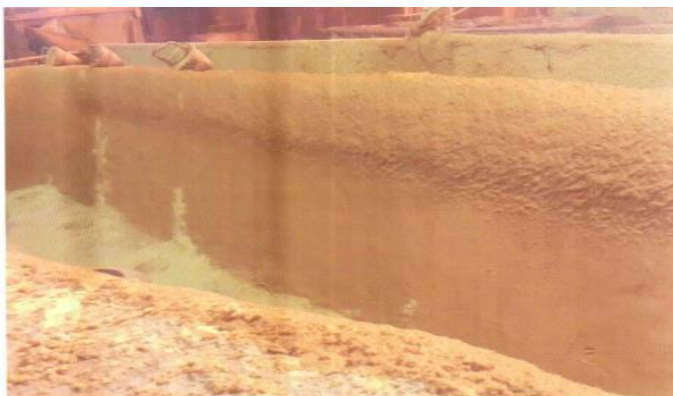
Рисунок 4.1 – Вид футерівки проміжного ківша після загладжування шару торкрету в зоні сталі
