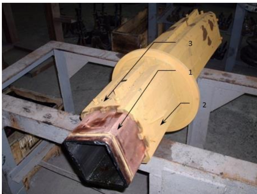
Малюнок 4.13– Гільза в обічайці (1 – мідна гільза, 2 – обічайка з нержавіючої сталі, 3 – гвинти, що центрують, для фіксації гільзи)
