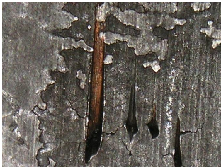
Рисунок 4.15 – Руйнування покриття на ділянках ерозії
