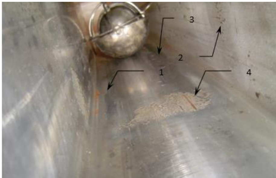
Рисунок 4.15 – Руйнування хромового покриття гільзи
