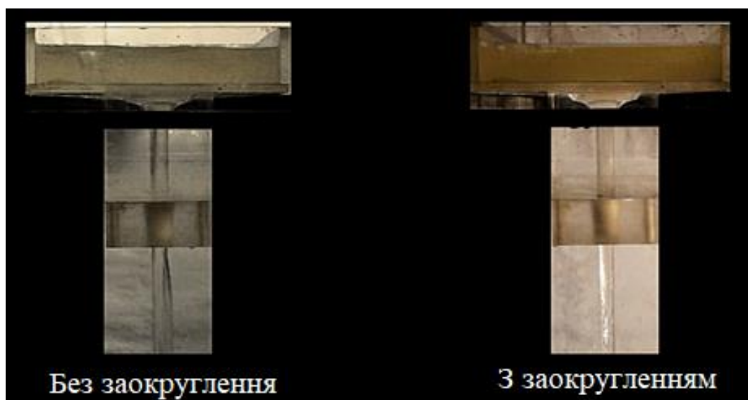
Рисунок 3.25 – Результати моделювання при використанні стаканів-дозаторів з діаметрами 16 мм (без заокруглення (а), та з заокругленням б).
