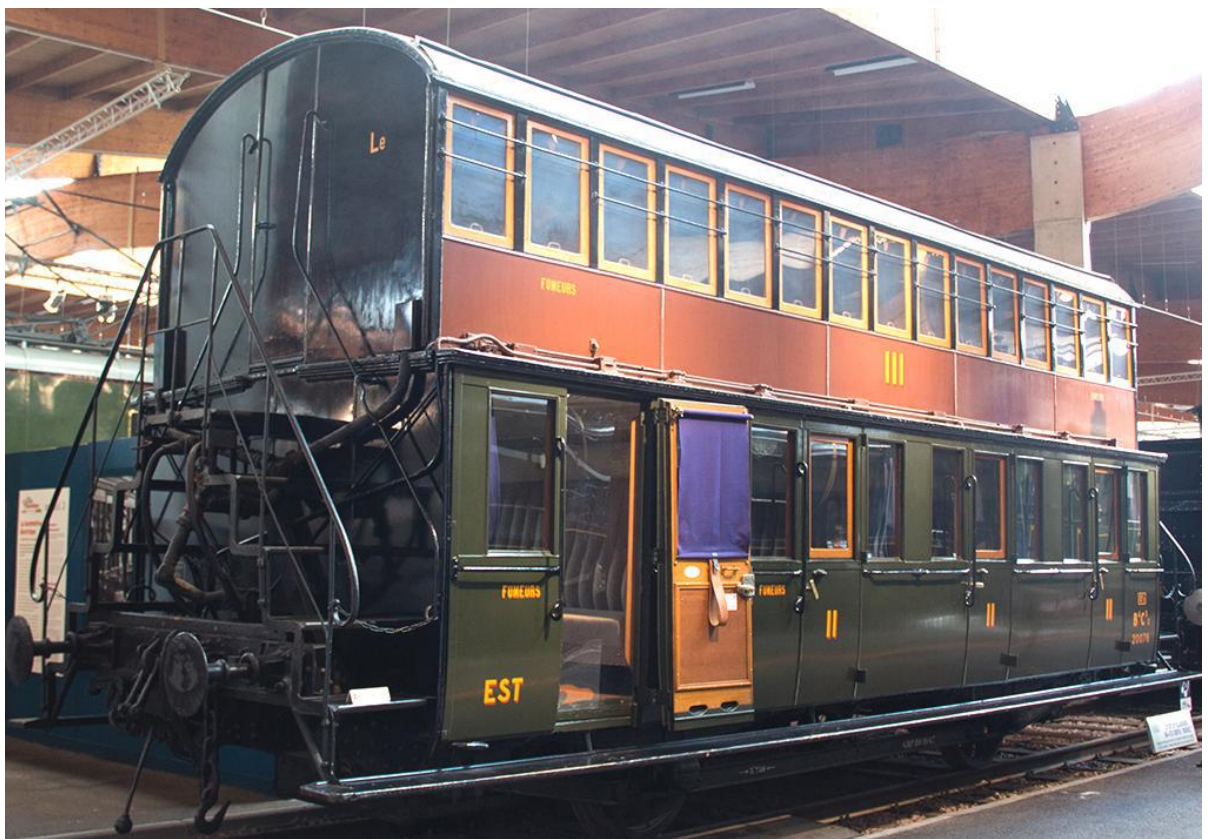
Рисунок 3 – Загальний вигляд двоповерхових вагонів Франції 19 ст. 80х років Масове використання двоповерхових пасажирських вагонів першими розпочали у Франції. З розвитком техніки і індустріалізації та зростанням пасажиропотоку в передмістях Парижа, Марселя, Ліона виникла потреба збільшення місткості екіпажу та заміни парку, застарілих морально та технічно, двоповерхових вагонів Bidel. У зв'язку з цим компаніями Entreprises Industrielles Charentaises (EIC) та Carel et Fouché для залізниць Франції Chemins de fer de l'État
