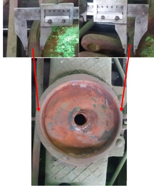
Рис. 1. Знос бурта підп'ятника вантажного вагона
