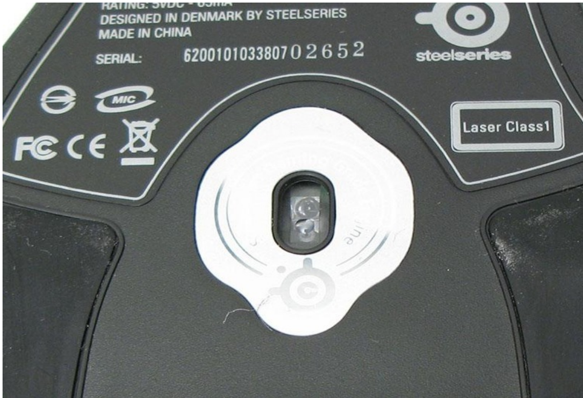
Рисунок 1.1 Інфрачервоний лазер оптичної лазерної миші
