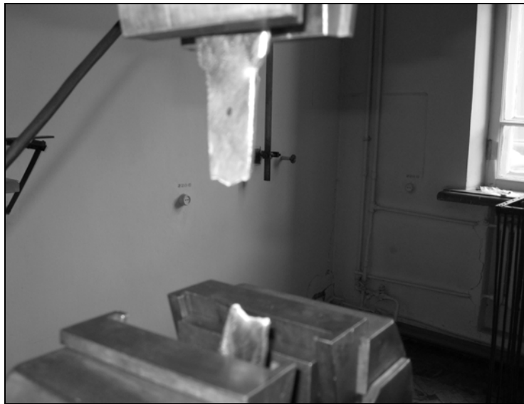
Рис. 3.7. Сталевий зразок у випробувальній машині до (а) та після (б) випробувань на розтяг
