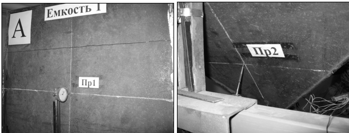
Рис. 3.20. Розташування прогиномірів на експериментальних ємностях
