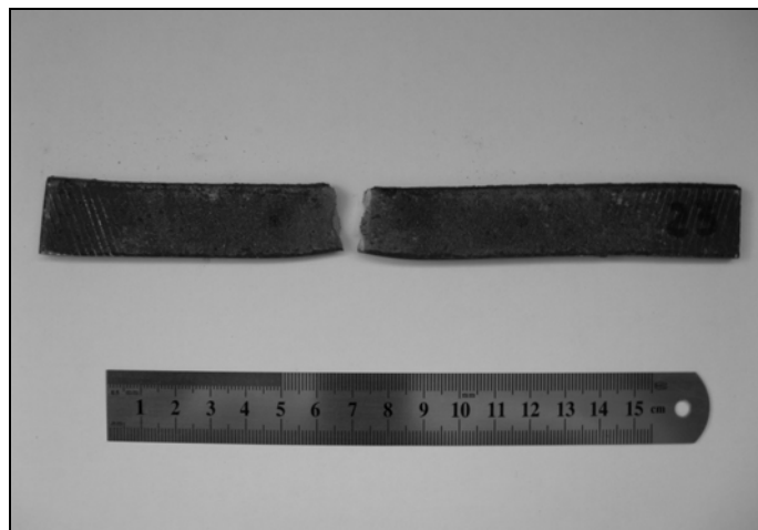
Рис. 3.8. Зруйновані після випробувань зразки серії 1 (а), серії 2 (б), серії 3 (в) і серії 4 (г)
