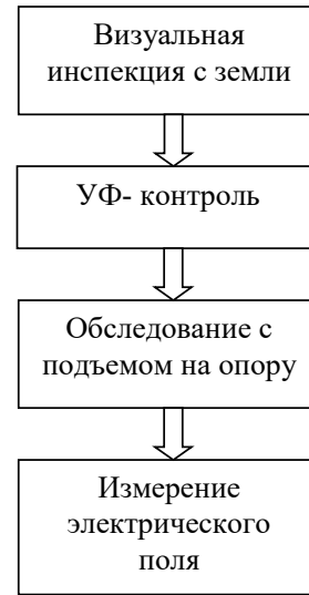
Рис. 1. Схема контроля ПИ, используемая в Италии
