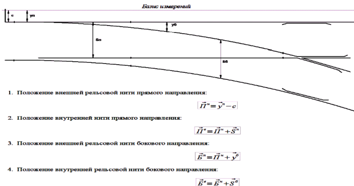
Рис. 3. Методика определения положения в плане стрелочного перевода
