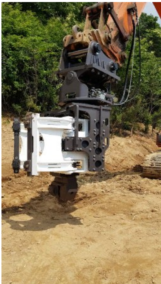
Рис. 1.21 Віброданурювач KD Hammer KVHS350 бічного типу
