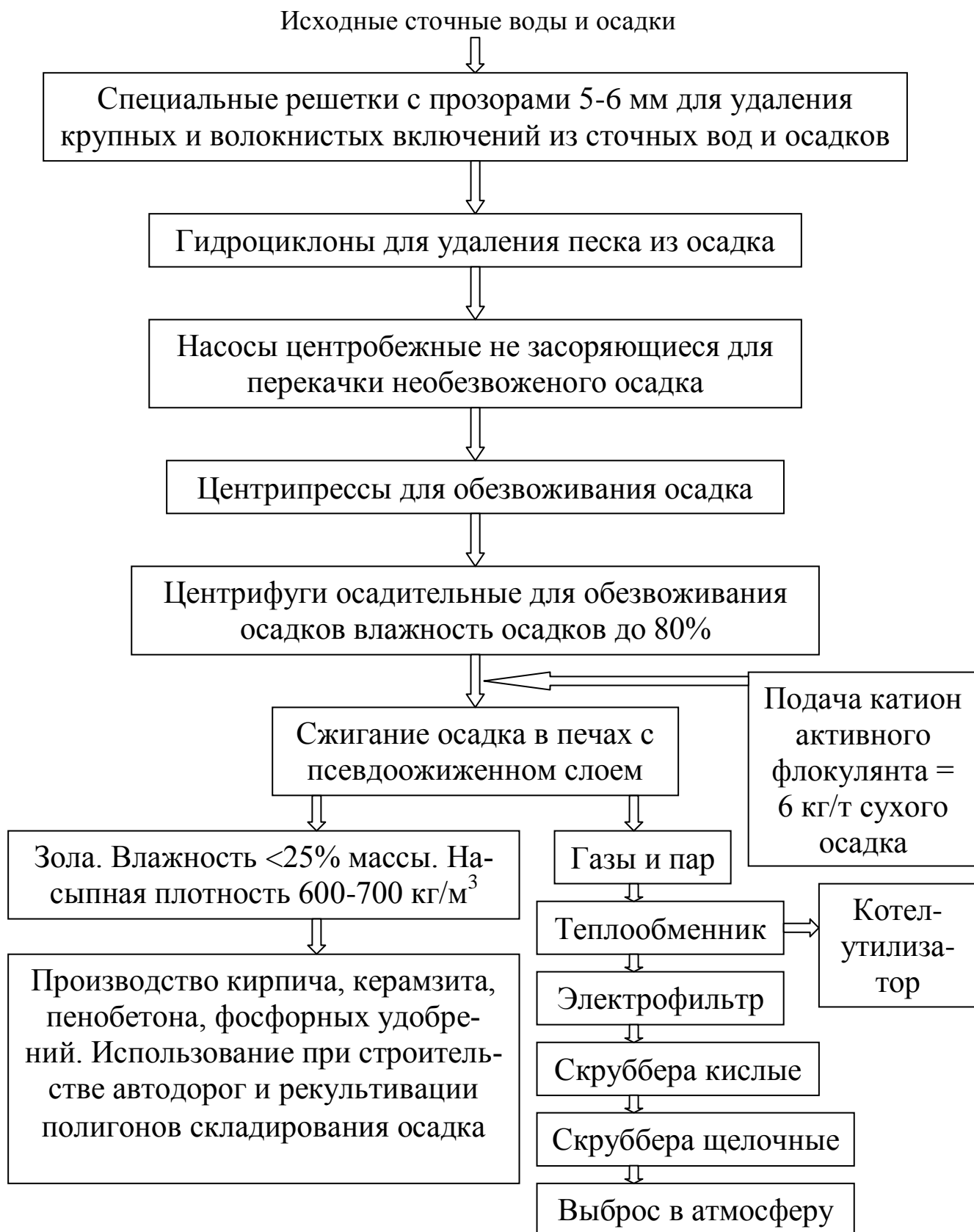
Рисунок 1. – Технологическая схема обработки осадка, канализационной станции города Винницы.
