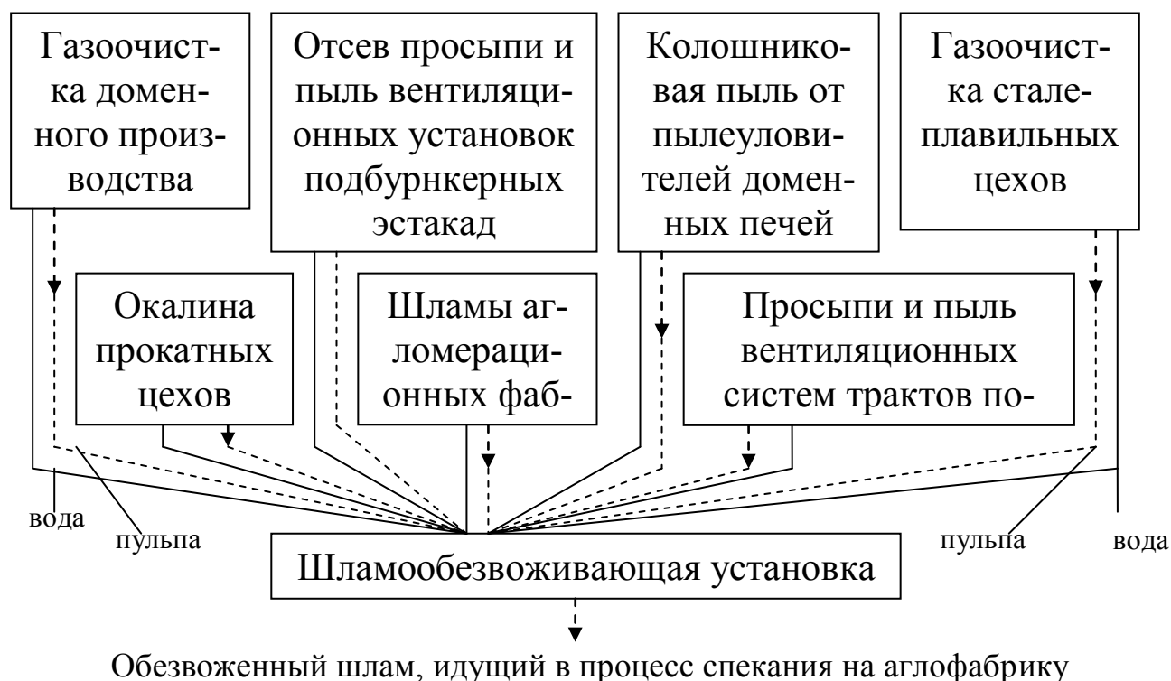
Рисунок 2. – Схема сбора и гидротранспорта металлсодержащих осадков из сточных вод к обезвоживающей установке и их утилизацию.
