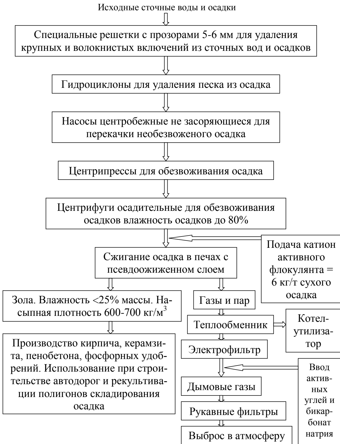
Рисунок 1. – Технологическая схема обработки осадка, канализационной станции города Полтавы.
