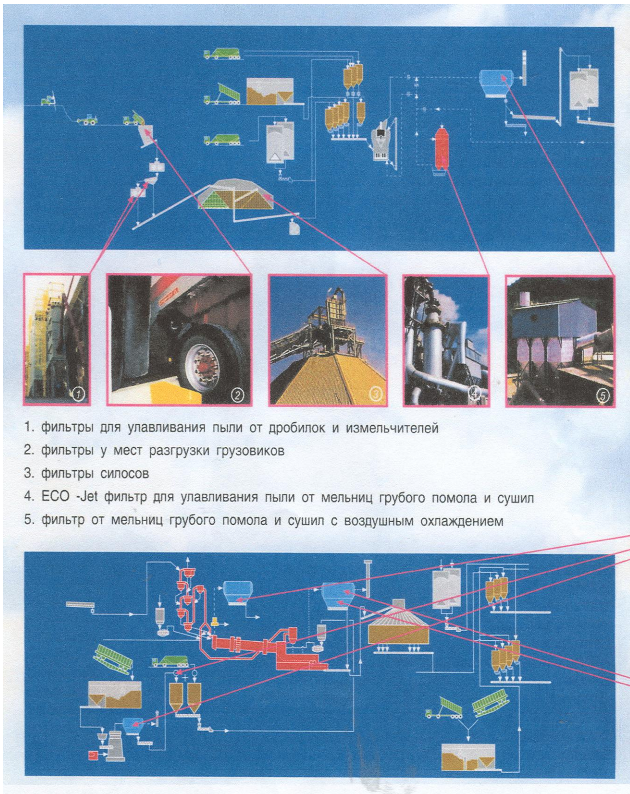
Рисунок 2. – Примеры использования различных типов фильтровальных агрегатов «INTENSIV FILTER» в комплексном технологическом цикле по производству цемента.
