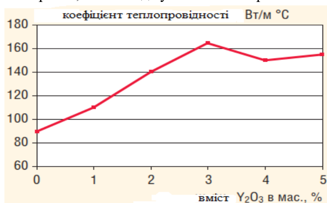
Рисунок 3 - Залежність коефіцієнта теплопровідності від кількості Y_2O_3 спікаючої добавки
