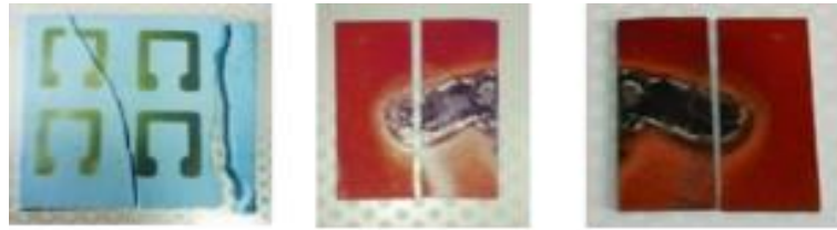
Рисунок 2 - Зовнішній вигляд зразків, що піддавалися перегріву та зруйнованих у процесі нанесення покриття
