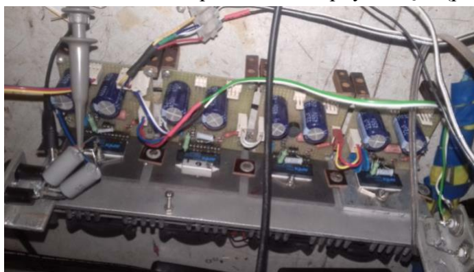
Рисунок 9 - Широкосмуговий високовольтний підсилювач з віртуальним живленням, який складається з чотирьох операційних підсилювачів, три з яких (ліворуч) розміщені на керамічних пластинах з нітриду алюмінію
