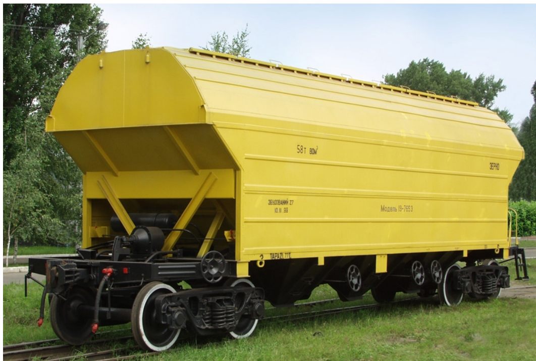
Рисунок 1.4 – Схема та загальний вигляд вагону для перевезення зерна моделі 19-765Э
