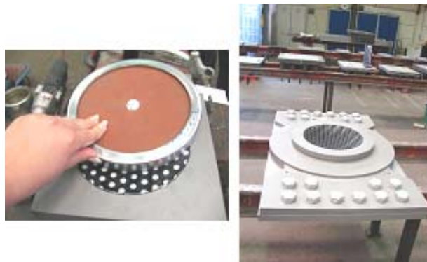
Рис. 2. Конструкция опорной части с применением материала «MSM®»
