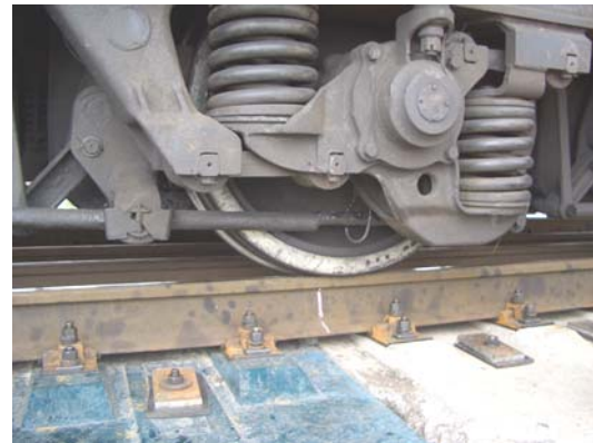
Рис. 4. Монтаж колії на плитах та встановлення локомотиву у характерній точці
