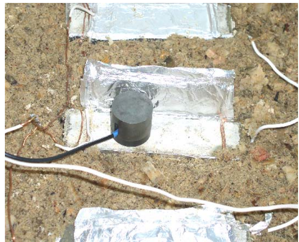
Рис. 1. Датчик акустичної емісії, встановлений на досліджуваному зразку
