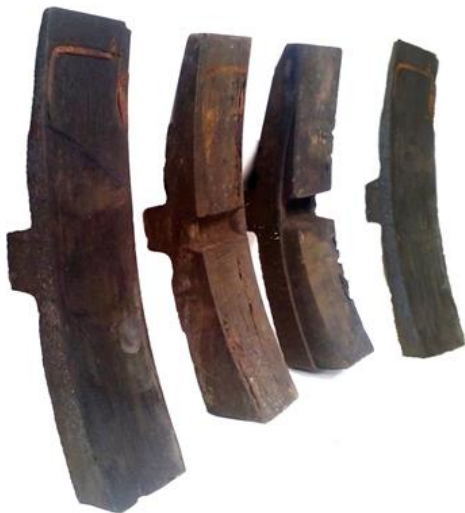
Рис. 3. Демонтовані гальмові колодки візків вантажних вагонів із клиноподібним ( a ) і дуальним ( б ) зносом (біла крива – це лінія розмежування площин)
