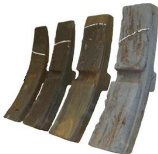
Рис. 3. Демонтовані гальмові колодки візків вантажних вагонів із клиноподібним ( a ) і дуальним ( б ) зносом (біла крива – це лінія розмежування площин)
