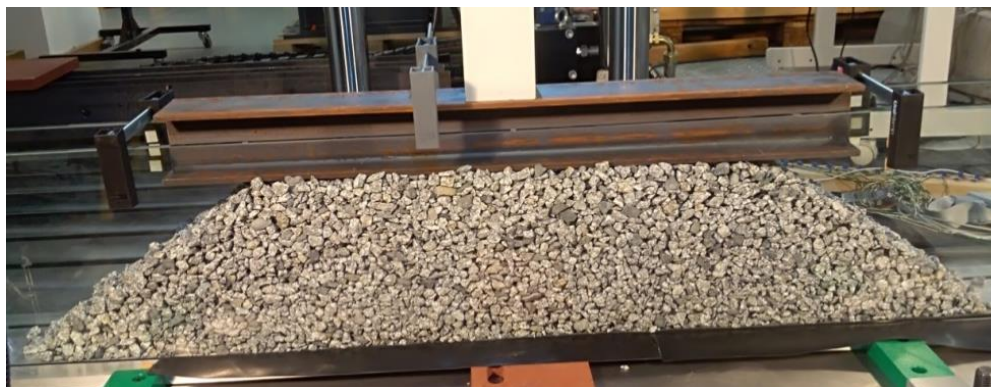
Рисунок 3.8 – Процесс уплотнения балласта гидропульсом
