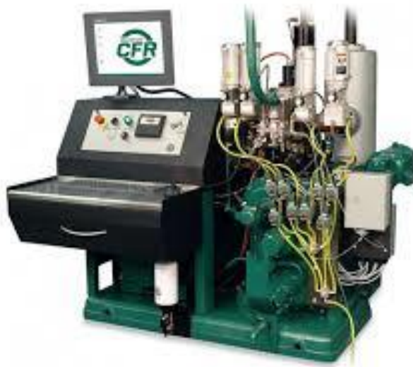
Рисунок 1.6 – Установка визначення цетанового числа дизельного палива
