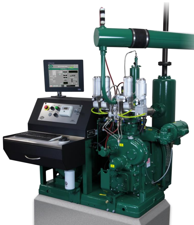
Рисунок 1.2 – Загальний вид установки для визначення октанового числа бензинів
