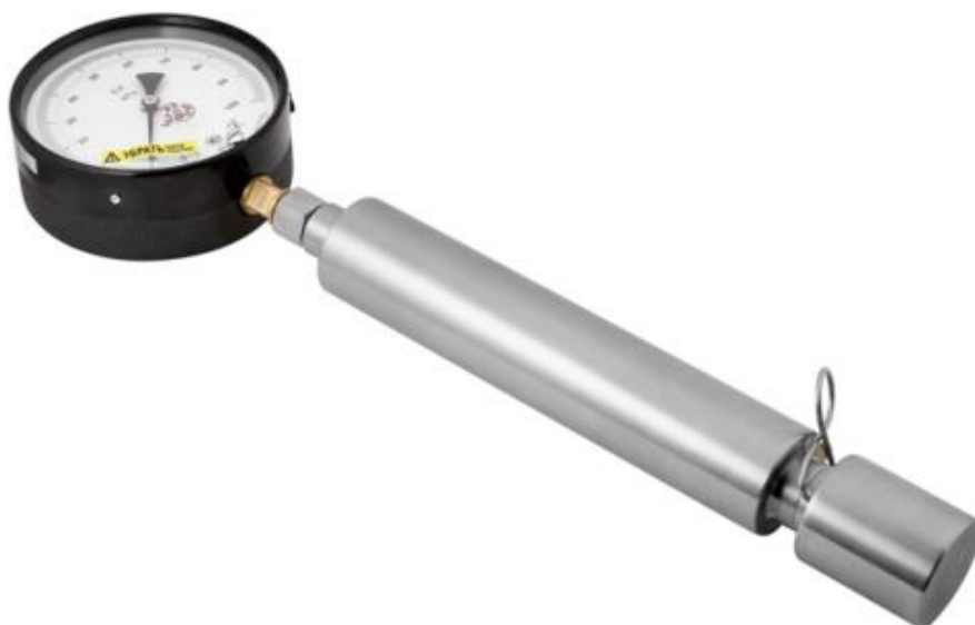
Рисунок 1.5 – Бомба для визначення тиску насиченої пари
