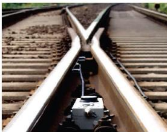
Рисунок 2.4 – Система ESAH-M для диагностики сердечника крестовины [23]
