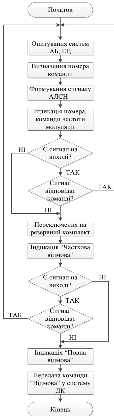
Рисунок 3.2 – Алгоритм роботи колійного генератора АЛСН+
