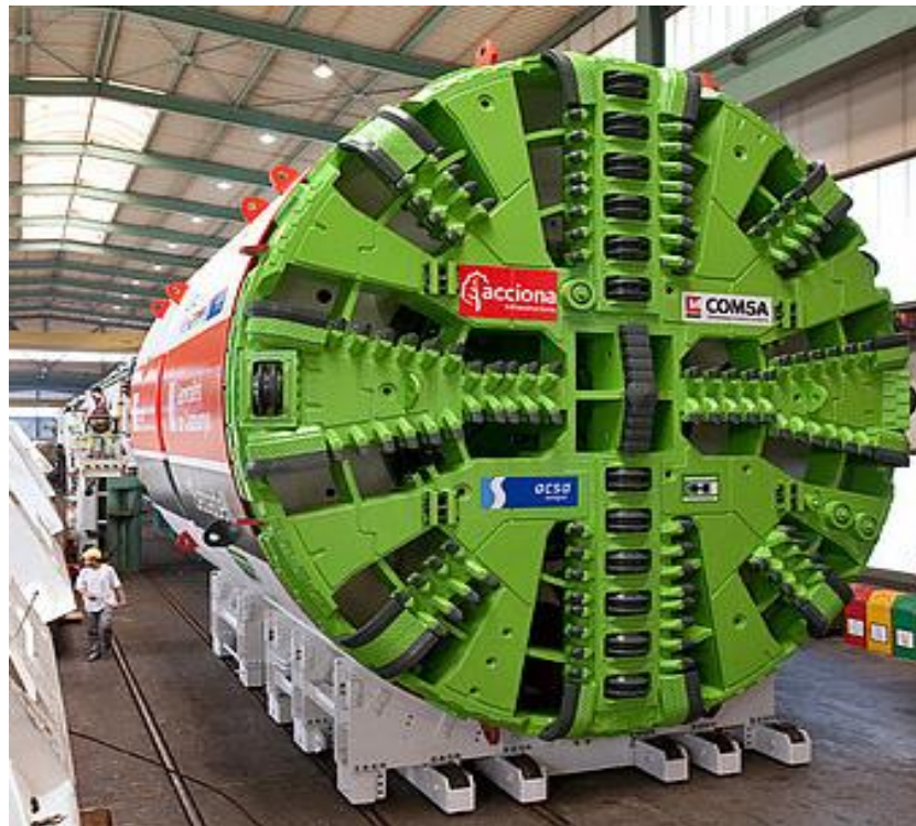
Рис.13.4. Робочий орган щита оснащений різцями дискового типу.
