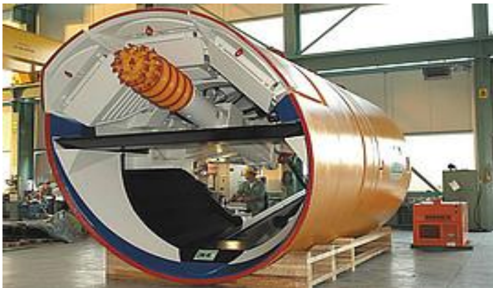
Рис. 11.8. Щит зі стріловим фрезерним робочим органом
