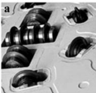
Рис. 13.7. Схеми розташування ріжучого інструменту на робочих органах щитів: а, б – шарошки дискового типу, в – стрижневі різці
