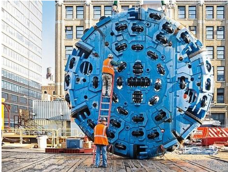
Рис. 16.4. Робочий орган ТПМК із одинарним щитом "Херренкнехт"
