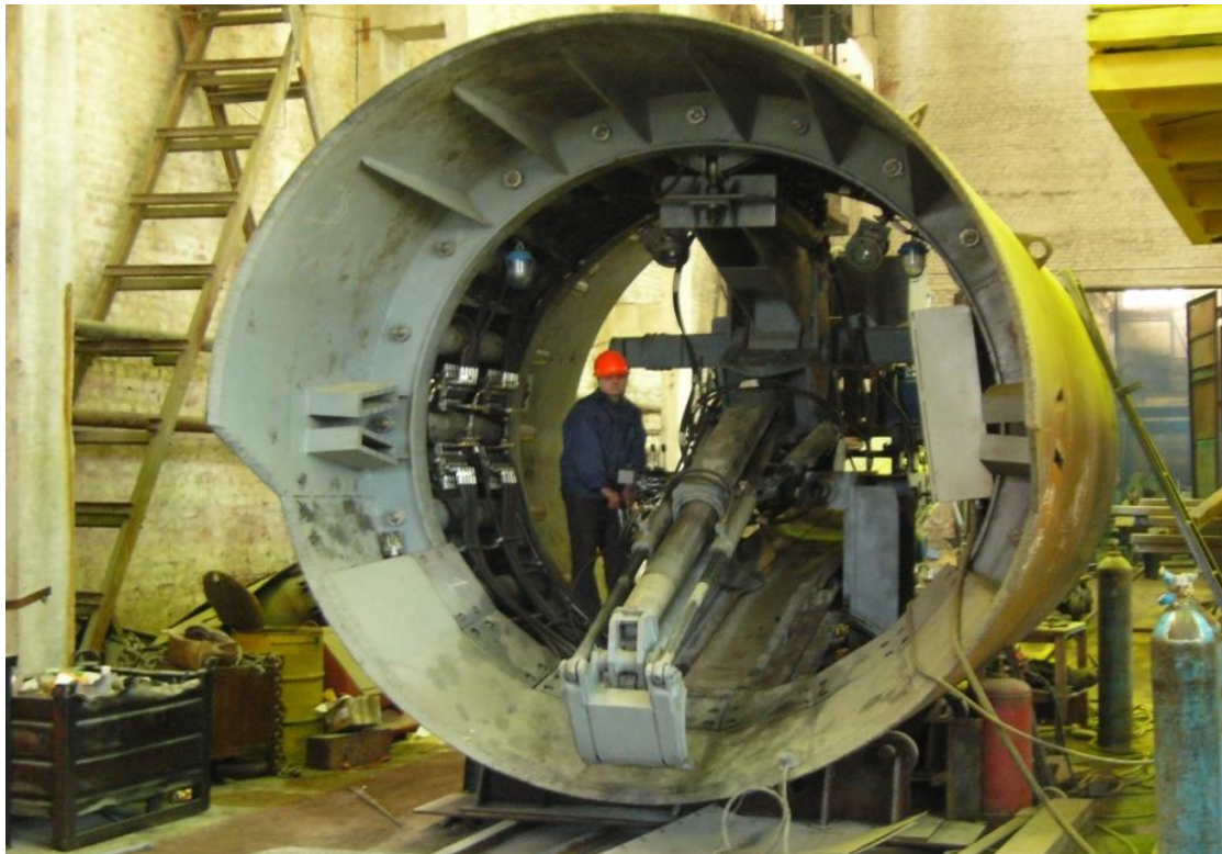
Рис. 11.4. Щит з екскаваторним робочим органом
