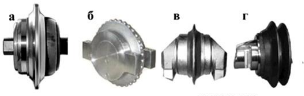
Рис. 13.6. Види дискових шарошок: а – Herrenknecht, б, в, г – Wirth.
