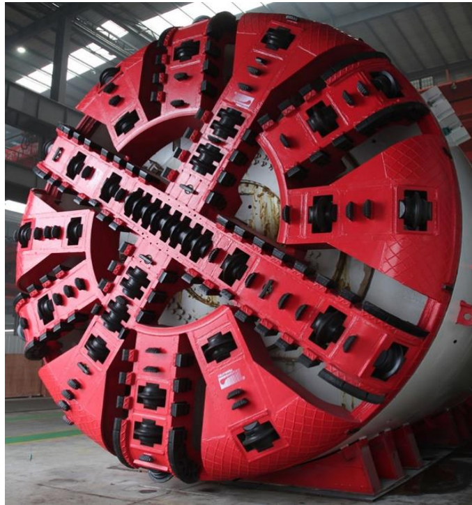
Рис. 13.4. Робочий орган щита роторного типу для розробки міцних порід
