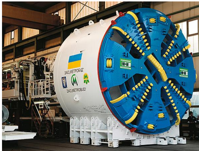
Рис.15.1. Щит фірми Herrenknecht при будівництві метро у м. Київ
