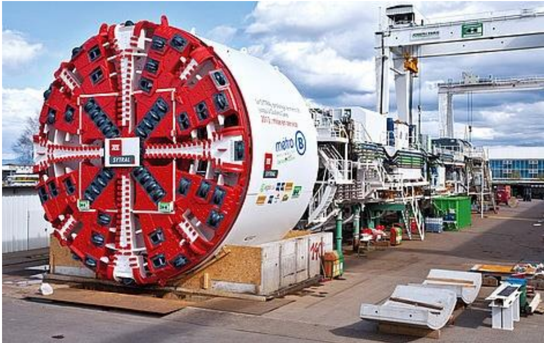
Рис. 15. 9. Миксцит (Mixshield) Herrenknecht на будівельному майданчику.
