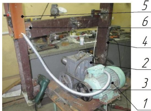
Рис. 3.6 – Механізм приводу канатного барабана лабораторного стенда: 1 – електродвигун; 2 – редуктор з барабаном тяговим; 3 – пасова передача; 4 – рама зварна; 5 – пульт керування електродвигуном; 6 – блоки, що відхиляють
