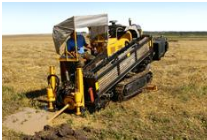
Рисунок 1.1. Установка ГНБ Vermeer класу midi
