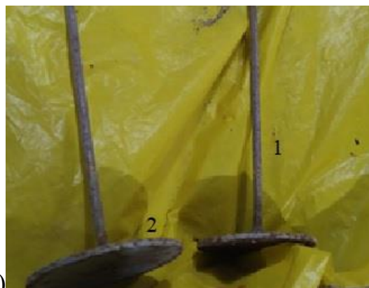
Рис. 3.10 – Вимірювання деформації ґрунту навколо отвору: а) – Короб з ґрунтом, щупами та відліковою планкою: 1 – ґрунт; 2 – планка відлікова; 3 – щуп; б) – Щупи: 1 – шток; 2 – опора.
