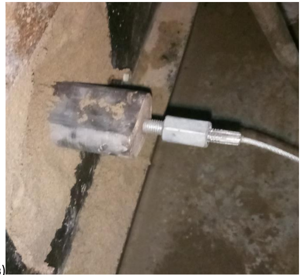
Рис. 3.2 – лабораторний стенд: а) – Схема стенду; б) – фото стенду; в) – заглиблення клинового РО: 1 – короб; 2 – робочі канати; 3, 4, 5, 6, 10 – блоки, що відхиляють; 7 – силовий тензометричний датчик; 8 – ваговий термінал; 9 – лінія числового зв'язку з ПК; 11 – канатний барабан; 12 – редуктор; 13 – клинопасова передача; 14 – електродвигун; 15 – магнітний пускач; 16 – частотний перетворювач; 17 – резистор керування частотним перетворювачем; 18 – розетка живлення вагового терміналу та ПК
