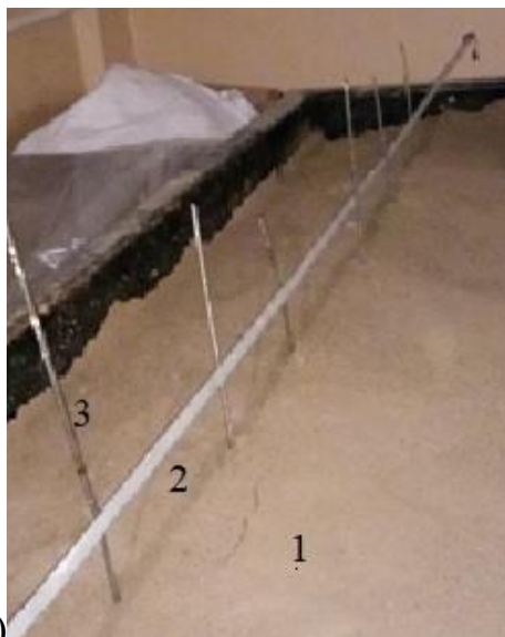
Рис. 3.10 – Вимірювання деформації ґрунту навколо отвору: а) – Короб з ґрунтом, щупами та відліковою планкою: 1 – ґрунт; 2 – планка відлікова; 3 – щуп; б) – Щупи: 1 – шток; 2 – опора.
