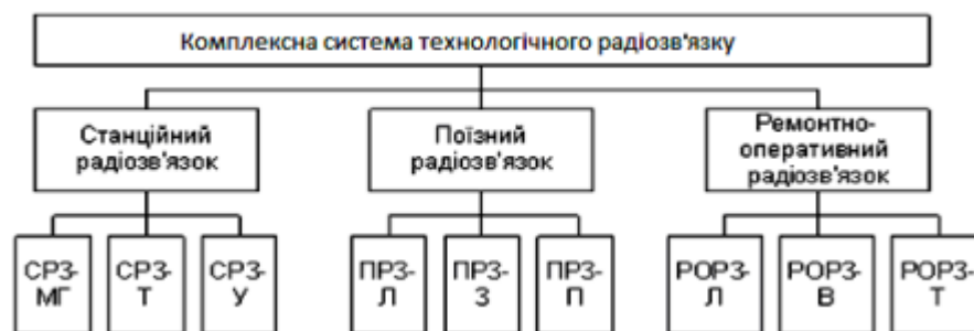
Рисунок 1.1 – Систематизація видів залізничного радіозв'язку
