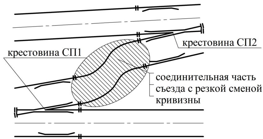
Рис. 1. Общая схема стрелочного съезда: СП1 – первый стрелочный перевод; СП2 – второй стрелочный перевод
