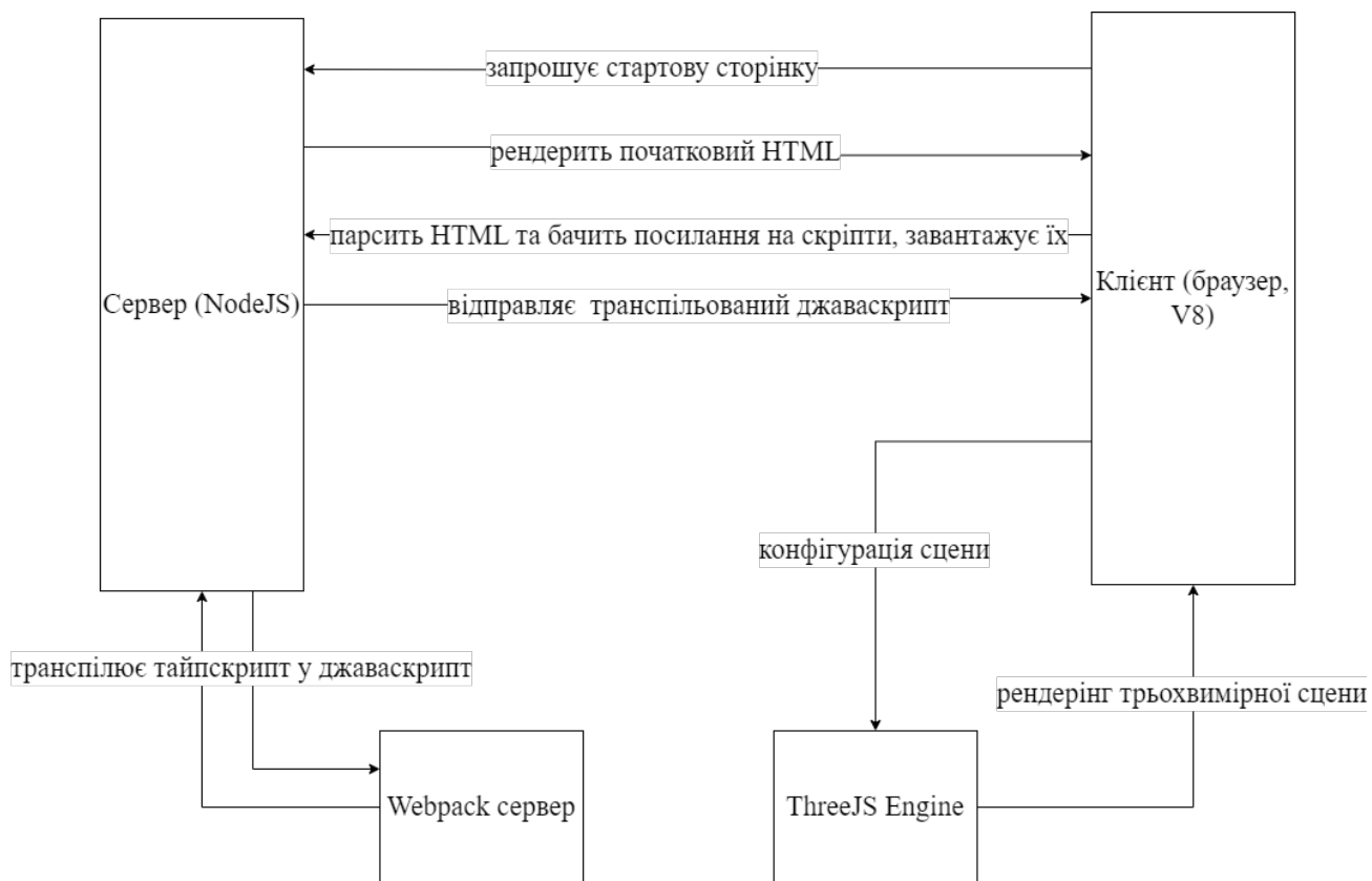
Рисунок 3.1 – Високорівнева архітектура програмного комплексу з генерації сцени з тривимірними фракталами
