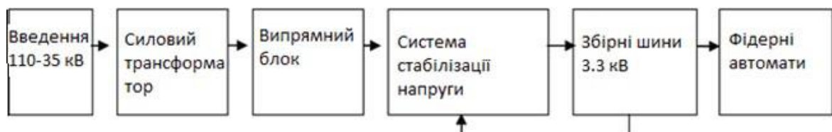
Рисунок 7.2- Структурна схема тягової підстанції з системою стабілізації напруги 3.3 кВ
