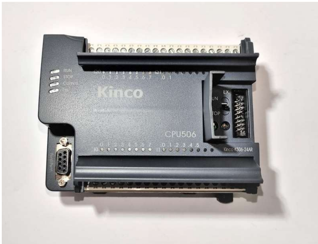
Рисунок 1.1 – Зовнішній вигляд програмованого логічного контролера Kinco K-506-24AR
