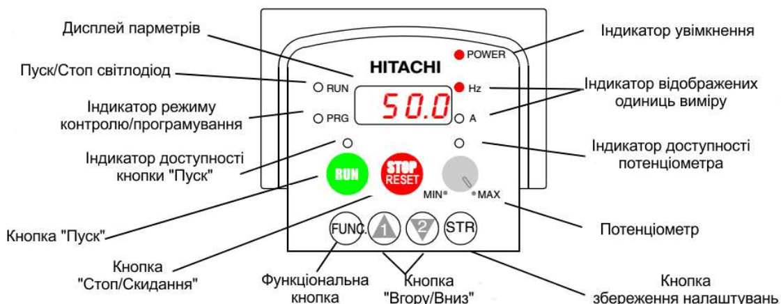
Рисунок 2.4 – Зовнішній вигляд і призначення елементів панелі керування інвертором
