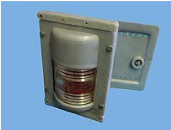
Рисунок 35 - Хвостовий сигнальний ліхтар вагона КБ-1641, (КБ-1640)
