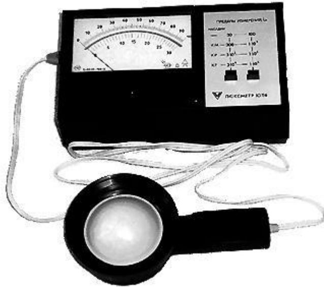
Рисунок 44 - Загальний вид люксметра типу Ю-116
