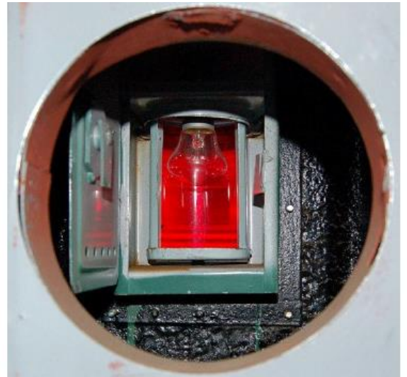
Рисунок 35 - Хвостовий сигнальний ліхтар вагона КБ-1641, (КБ-1640)
