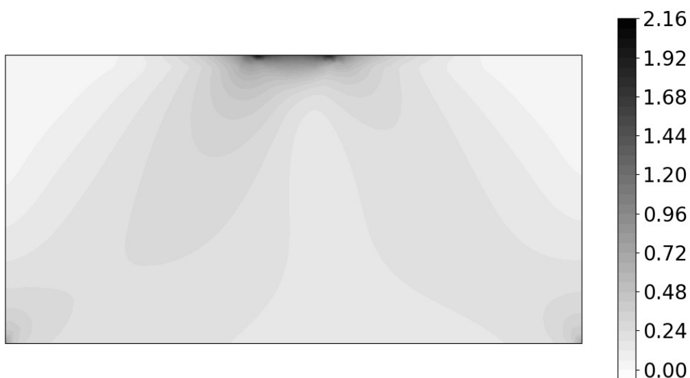
Рисунок 4.2 – Розподіл напружень у формі Мізеса в досліджуваній конструкції, 10^9 Па
