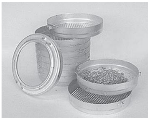
Рис. 1.1 Набір стандартних сит для просіювання піску
