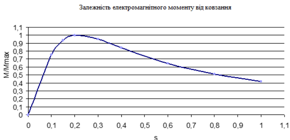
Рис.2.2. Механічна характеристика асинхронного двигуна МСТ-0.25
