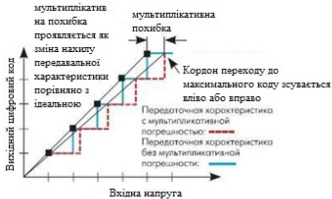
Рис. 2.10. Мультиплікативна похибка (Full-Scale Error)
