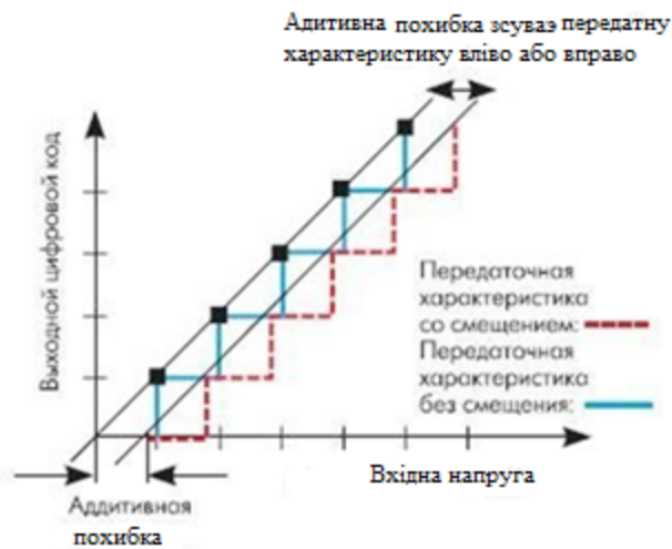
Рис. 2.9. Адитивна похибка (Offset Error)
