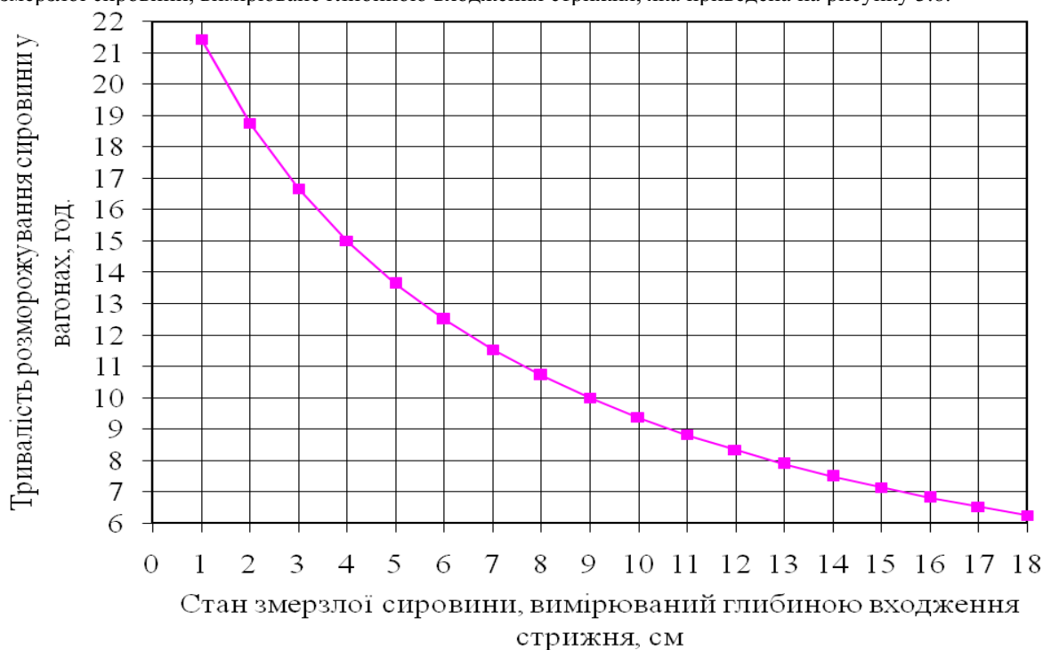
Рисунок 3.8 – Залежність тривалості розморожування сировини у вагонах від стану змерзлої сировини, вимірюваний глибиною входження стрижня
