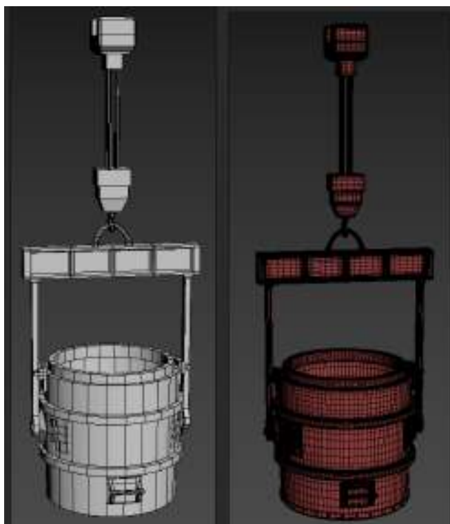
Рисунок 7 – Лоуполі та хайполі модель розливної ковша
