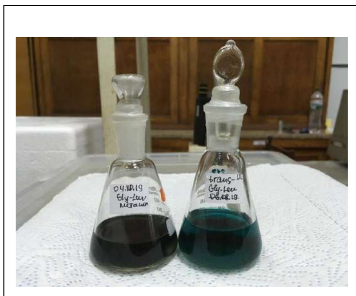
Рис. 2.3 – Реакційна суміш (\text{NBu}_4)_2\text{Re}_2\text{Cl}_8 з дипептидом Gly-Leu, через декілька годин після змішування: зліва – в метанолі, з правого боку – в ацетонітрилі
