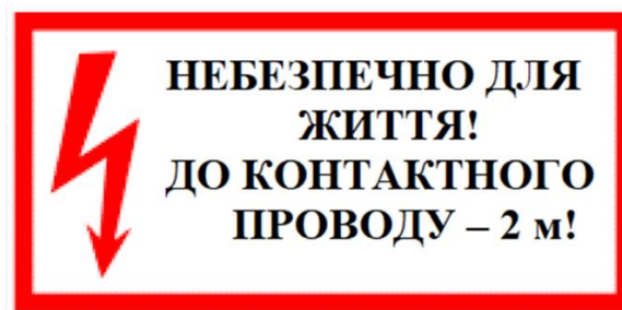
Рисунок 4.1 – Попереджувальний знак червоного кольору з написом «НЕБЕЗПЕЧНО ДЛЯ ЖИТТЯ! ДО КОНТАКТНОГО ПРОВОДУ – 2 м!»
