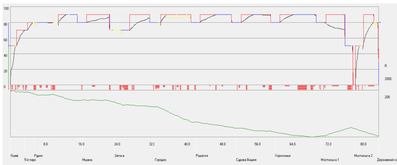
Рисунок 2.17 – Графік кривої швидкості Львів-Мостиська 2 (верхня крива), план (червоний колір) і поздовжній профіль ділянки (зелений колір)
