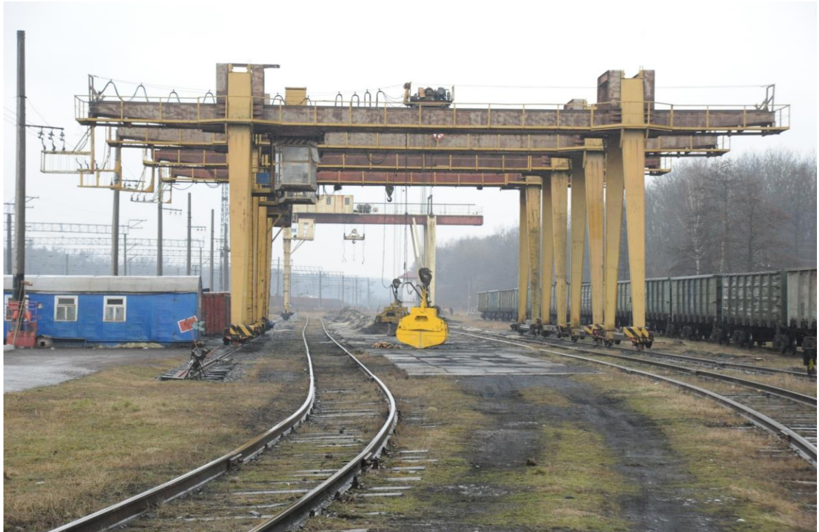
Рисунок 2.6 – Козлові крани на ст. Мостиська-2 для навантаження й розвантаження сипучих вантажів
