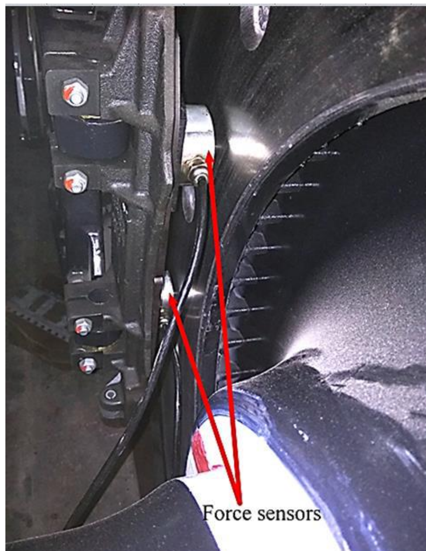
Рисунок 2.2 - Установка датчиків натиснення при визначенні сили натискання на накладку.
