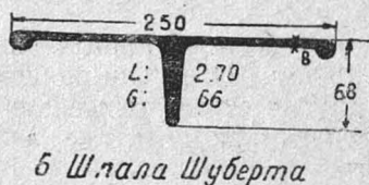
Фиг. 21. Железные шпалы (1:6) Австрии и Германии.
