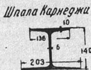
Фиг. 21. Железные шпалы (1:6) Австрии и Германии.
