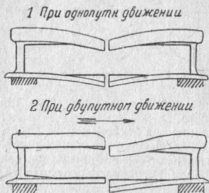
Фиг. 188. Износ рельса и накладок на стыке.
