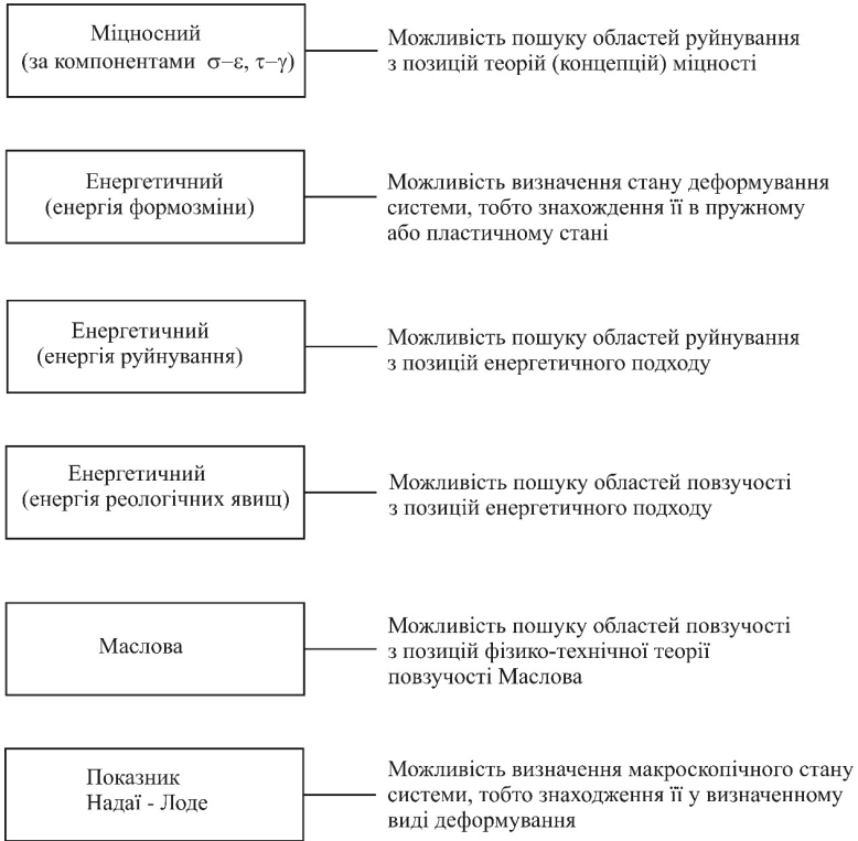
Рис. 2.7. Схема фільтрів з коротким поясненням їхніх дій
