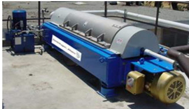
Рис. 1. Трифазна декантер-центрифуга для переробки нафтошламу ZA 18-4
