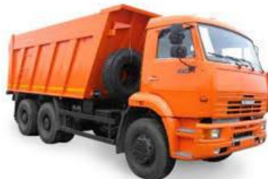
Рисунок 2.4 – Автосамоскид МАЗ-6501С3, вантажопідйомність 15 тонн
