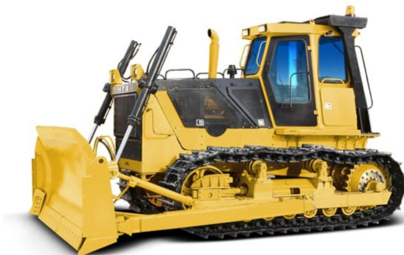
Рисунок 4.5 – Бульдозер Д180 потужністю 132 кВт (180 к.с.)
