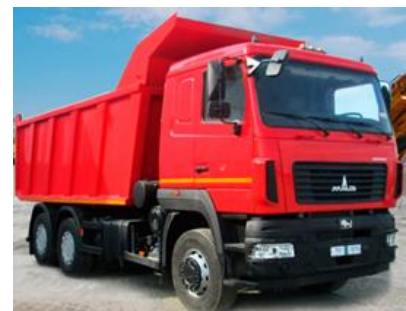
Рисунок 2.5 – Автосамоскид МАЗ-6501С5, Вантажопідйомність 20 тонн
