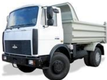
Рисунок 2.3 – Автосамоскид МАЗ-6501С2, вантажопідйомність 10 тонн
