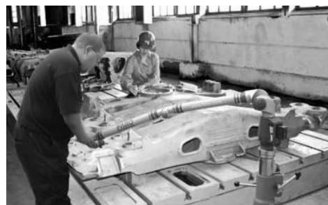
Рис. 4. Контрольно-вимірювальний маніпулятор геометричних параметрів надресорної балки
