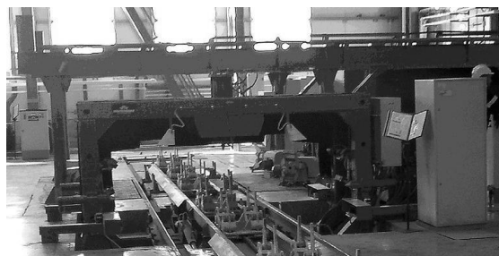
Рис.2. Стенд автоматизованого випробування та обміру вагонних візків
