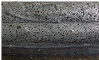
Рис. Наплавлений метал порошковим дротом ПП-Нп-14Х12Г12СТ під флюсом АН-26П
