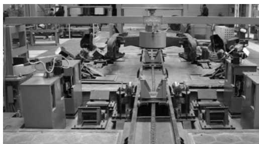
Рис.1. Установка автоматичного контролю литих деталей візків вантажних вагонів
