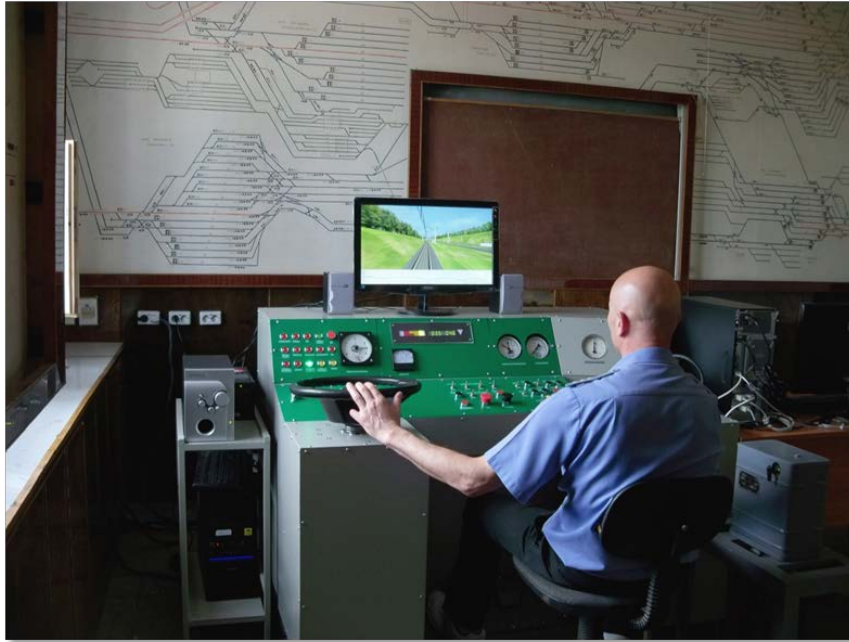
Навчальний тренажер машиніста електропоїзда ЕПЛ2Т, Ясинувата, РПЧ – 2013 рік
