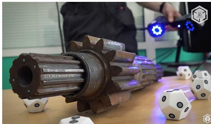
Рисунок 1 – 3Д сканування валу-шестерні
