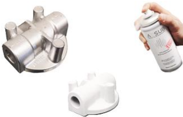
Рисунок 1 – Матування деталі для 3Д сканування Рисунок 2 – Деталь з нанесеними маркерами на поверхні
