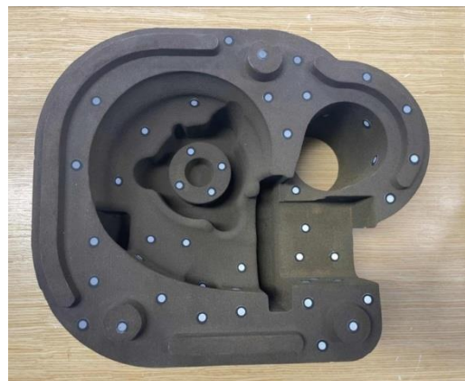
Рисунок 1 – Матування деталі для 3Д сканування Рисунок 2 – Деталь з нанесеними маркерами на поверхні
